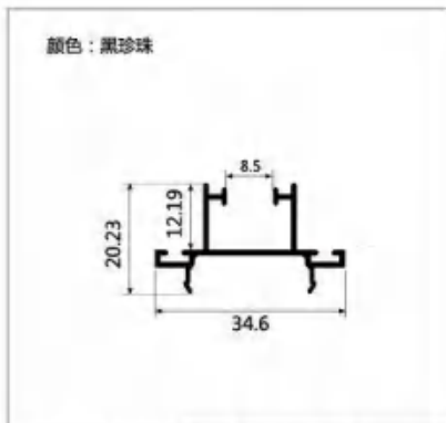
型号:LBW231 名称:推拉收口 壁厚:1.0mm 重量:0.25kg/m 长度:4.8m
