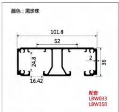
型号:LBW259 名称:双吊轨(凹轮) 壁厚:2.0mm 重量:1.905kg/m 长度:6m
