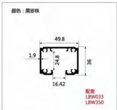
型号:LBW270 名称:单吊轨(凹轮) 壁厚:1.9mm 重量:1.025kg/m 长度:6m
