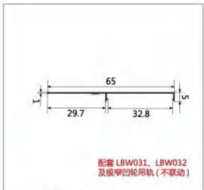
型号:LBW033 名称:凹轮吊轨盖板 壁厚:1.0mm 重量:0.197kg/m 长度:6m
