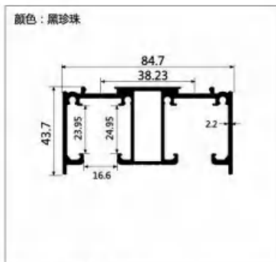
型号:LBW237 名称:双吊轨(凹轮) 壁厚:2.2mm 重量:1.97kg/m 长度:6m
