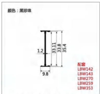
型号:LBW279 名称:40/50凹轮吊轨拼条 壁厚:1.2mm 重量:0.158kg/m 长度:6m
