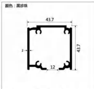
型号:LBW224 名称:单吊轨(平轮) 壁厚:2.0mm 重量:1.01kg/m 长度:6m
